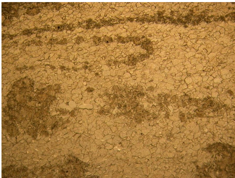
Figura 26 - Strutture geometriche assimilabili a pieghe isoclinali che costituiscono la "greca" che caratterizzano la tipologia marmo detto Bianco Grecato. Dall'immagine si nota anche un'intensa dolomitizzazione post-metamorfica che si imposta su probabili livelli originari a maggiore composizione dolomitica. Foto a Nicol paralleli.
