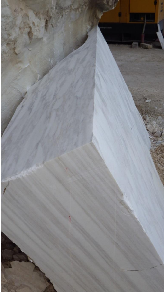
Figura 24 - Differenti aspetti di ornamentazione su tre facce di un blocco di "Calacatta" dovuto all'elevata deformazione dei clasti marmorei.
