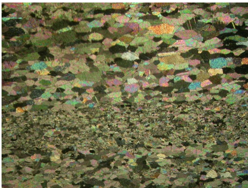
Figura 30 - "Arabescato tipo Forno" in sezione sottile a Nicol incrociati (la lunghezza della foto rappresenta la lunghezza di 1 mm nella sezione sottile). Dalla foto si nota una distribuzione bimodale della dimensione dei cristalli di Calcite.
