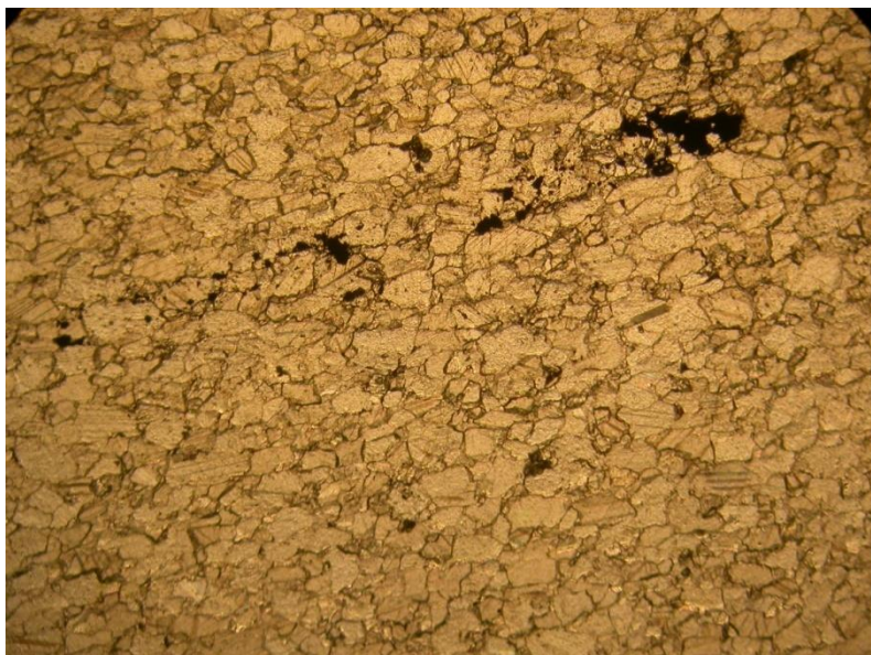
Figura 36 - Livello di ossidi opachi che sembrano marcare la scistosità principale della roccia. Foto a Nicol paralleli.
