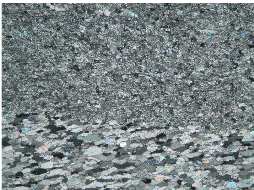
Figura 37 - Sezione sottile a nicol paralleli di un campione di marmo foliato della cava Borre Mucchetto.
