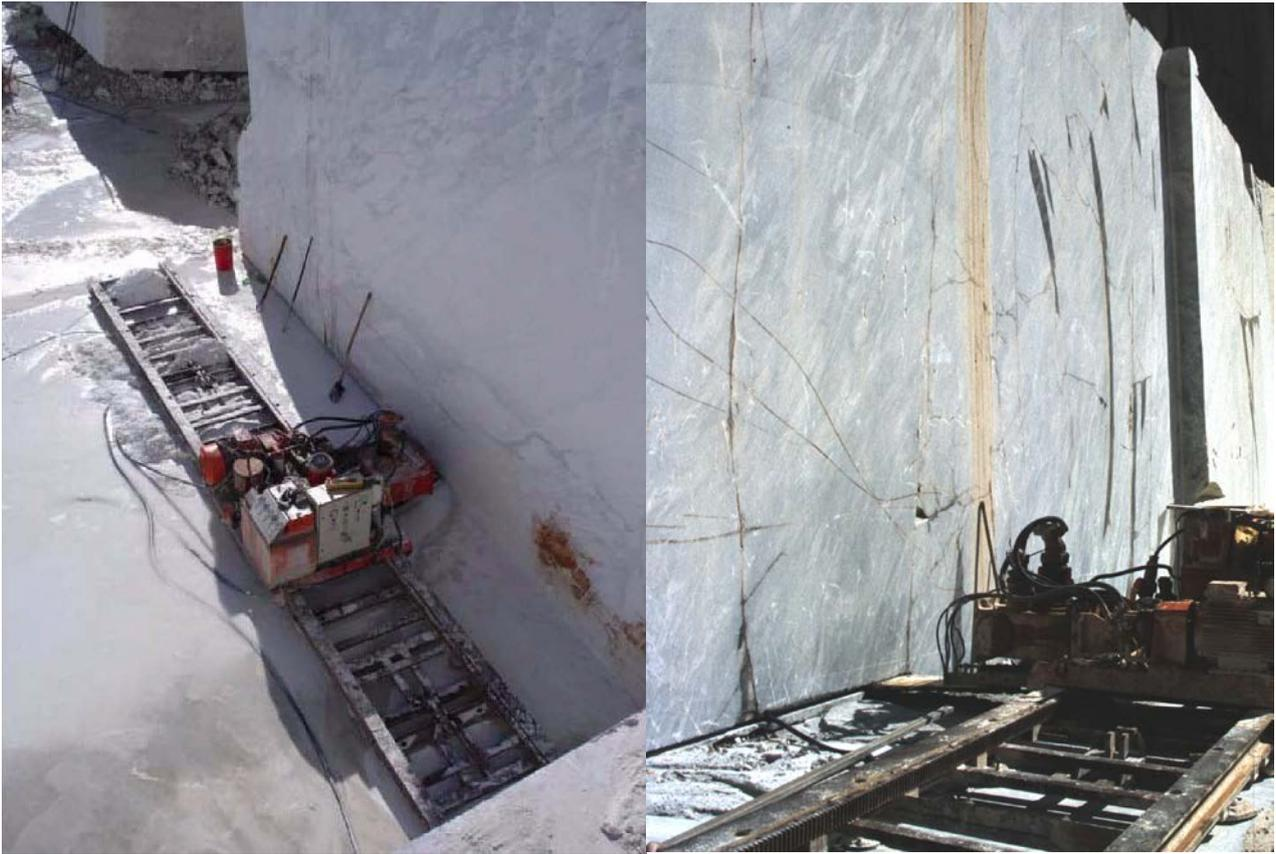
*Figura 78 - Tagliatrici a catena posizionate per il taglio orizzontale delle bancate.*
