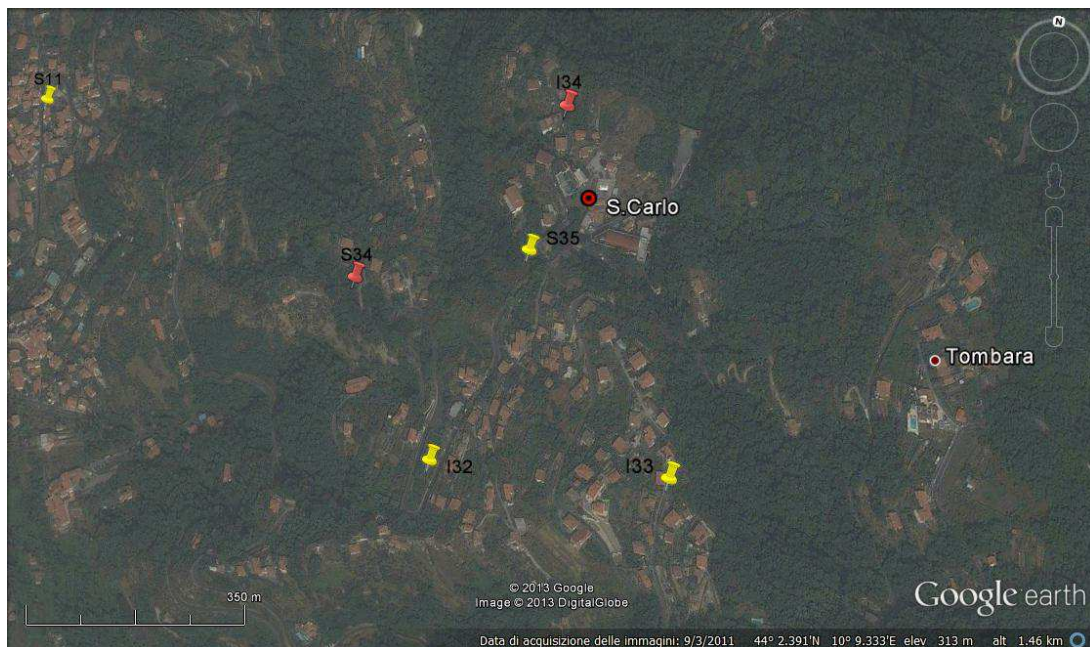
Figura 5.11.1 – Ubicazione delle misure di vibrazioni ambientali a stazione singola effettuate nei pressi dell'abitato di S. Carlo Terme. I colori dei segnaposto si riferiscono alla qualità della misura HVSR (verde: livello \alpha ; giallo: livello \beta ; rosso: livello \gamma ).
