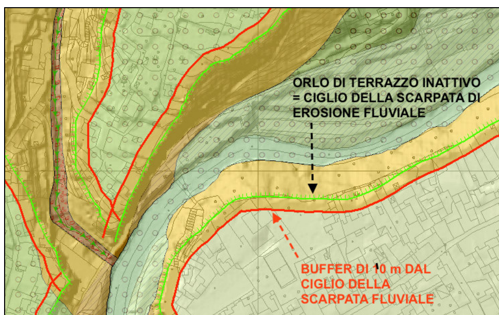
Fig 4.1. Posizione della scarpata fluviale del F. Frigido in località Borgo del Ponte e buffer delimitante la fascia di rispetto. In corrispondenza della scuola materna (edificio indicato dalla punta della freccia rossa) la scarpata fluviale presenta un'altezza massima di circa 23 m. In alto a sinistra è visibile la scarpata associata al canale del Rotino
