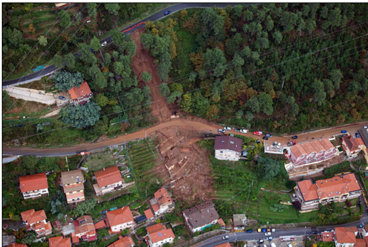
Fig. 3.1 Frana di tipo complesso in località Lavacchio originata da un movimento di scorrimento evoluto poi in una colata di detrito (debris flow) molto rapida (31 Ottobre 2010)
